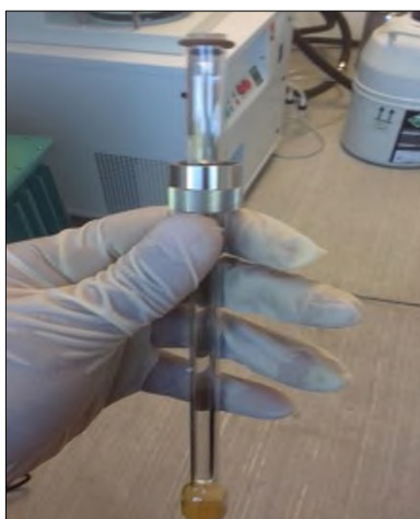
Figura 30. Celda de vidrio utilizada en la medición de área superficial por el método de BET.
