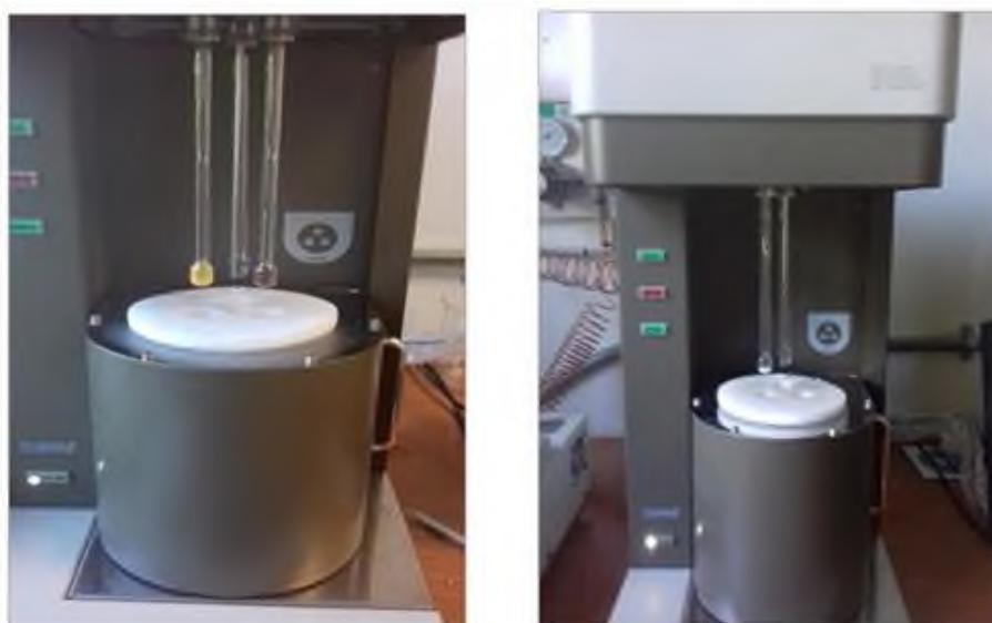
Figura 31. Equipo de BET BELL master. Permite la medición de dos muestras simultáneamente (izquierda) o de una sola (derecha). El puerto 1 y 3 es para las muestras y el puerto 2 sirve como referencia.
