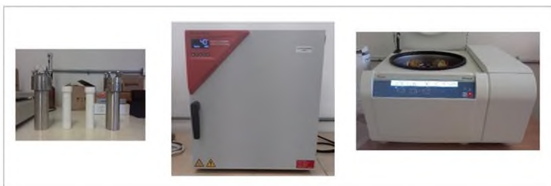
Figura 19. Equipos utilizados en el proceso de síntesis solvotermal. De izquierda a derecha: Reactores y encamisados de teflón, horno y centrifuga.
