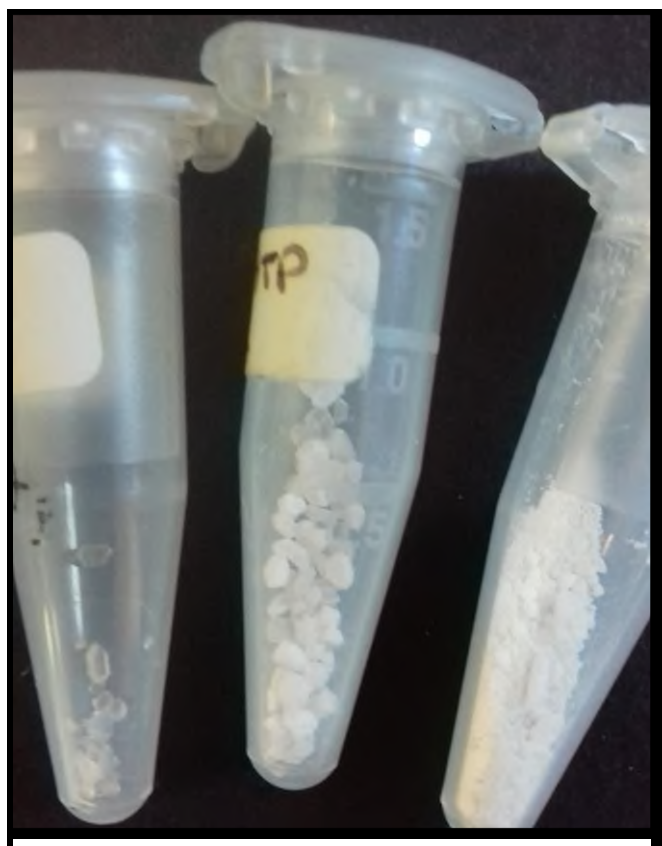
Figura 37. Efecto del tratamiento térmico (TT) en la morfología de la muestra de Zn-DHTP. Ordenada de izquierda a derecha: producto de la síntesis solvotermal, sometida a TT de 80°C y sometida a TT de 200°C.
