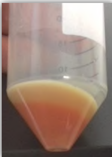
Figura 71. Muestra del material del sistema Al-DHTP. Se considera que la división de colores que se observa corresponde a las distintas fases cristalinas presentes en el material.
