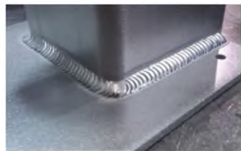
Figura 26: Sistema de unión por soldadura.
