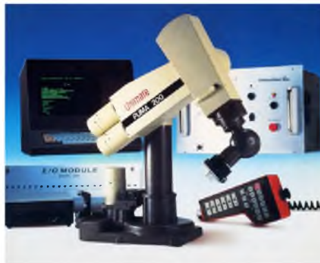
Figura 4: Robot PUMA desarrollado por Victor Scheinman en 1975.
