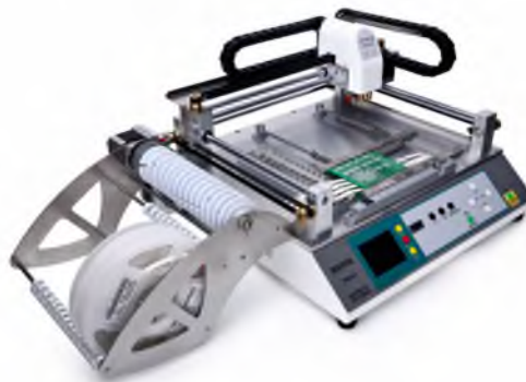
Figura 8: Robot de armado de tarjetas electrónicas, sitúa los diferentes componentes electrónicos en la tarjeta de circuitos impresa a una gran velocidad.
