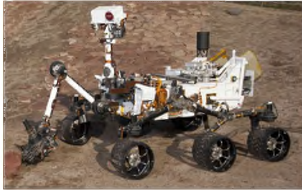
Figura 10: Robot terrestre de locomoción por ruedas Curiosity construido por NASA y puesto en operación en 2012.
