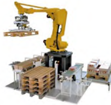
Figura 7: Robot cuya función ha sido programada para el paletizado automático en una línea de producción.
