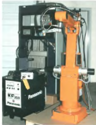
Figura 3: Robot IRB6 controlado por microprocesador Intel de 8 bits desarrollado por ABB.
