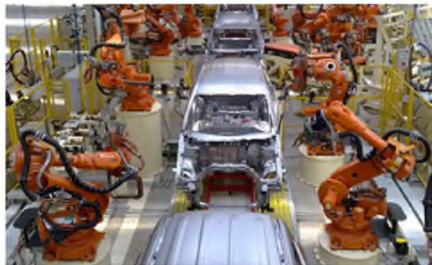
Figura 6: Proceso de soldado de partes del chasis de automóviles, en una línea de producción automatizada mediante robots.
