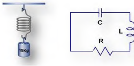
Figura 2.2: a) Sistema masa-resorte, b) Circuito RLC
