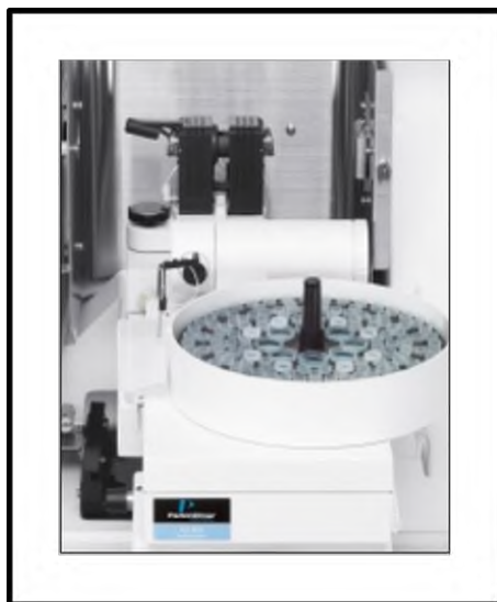
Figura 21. Automuestreador AS-800, con capacidad para 146 muestras con pipeteo automático.
