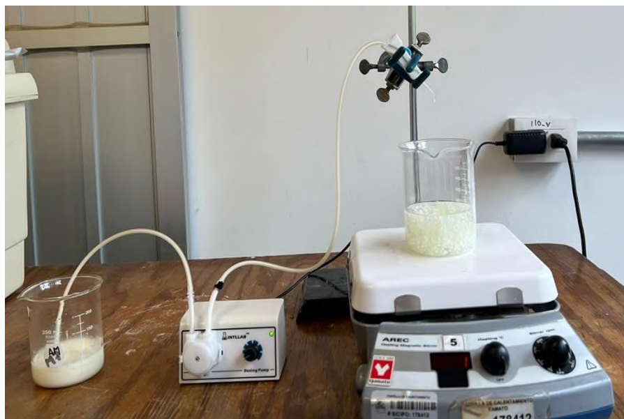
Figura 6.0.2 Sistema de encapsulación por gelificación iónica externa.
