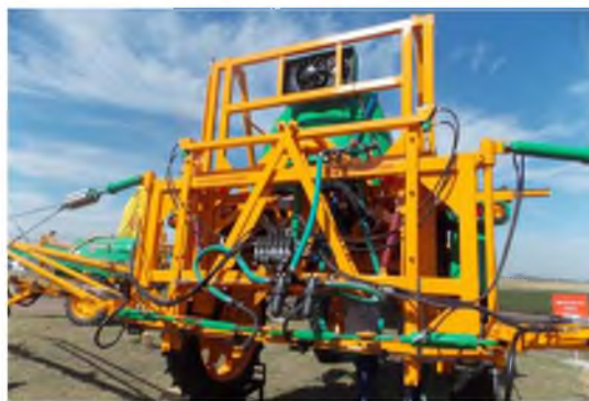
Figura 1.5: Pulverizadora autopropulsada modelo AR 3.4 S2 de la compañía PRABA con el sistema de botalón central basculante, ver en [19].
