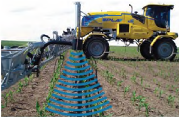
Figura 1.7: Pulverizadora autopropulsada PLA con barras hidráulicas articuladas y controlados con el sistema de control de altura de NORAC [13].
