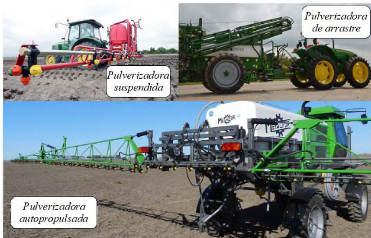
Figura 1.1: Clasificación de sistemas de barras pulverizadoras de acuerdo a sus dimensiones y forma de transporte.
