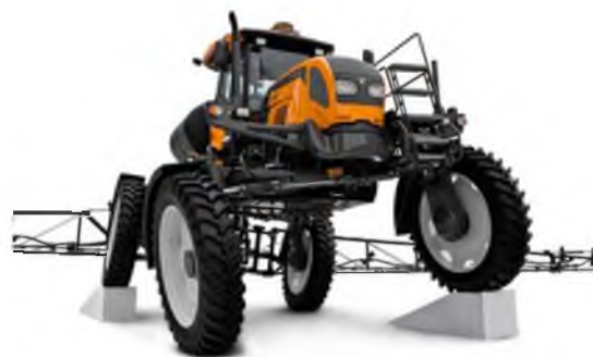
Figura 1.4: Pulverizadora autopropulsada VALTRA BS3020H con suspensión activa para mantener la estabilidad del vehículo, ver en [26].
