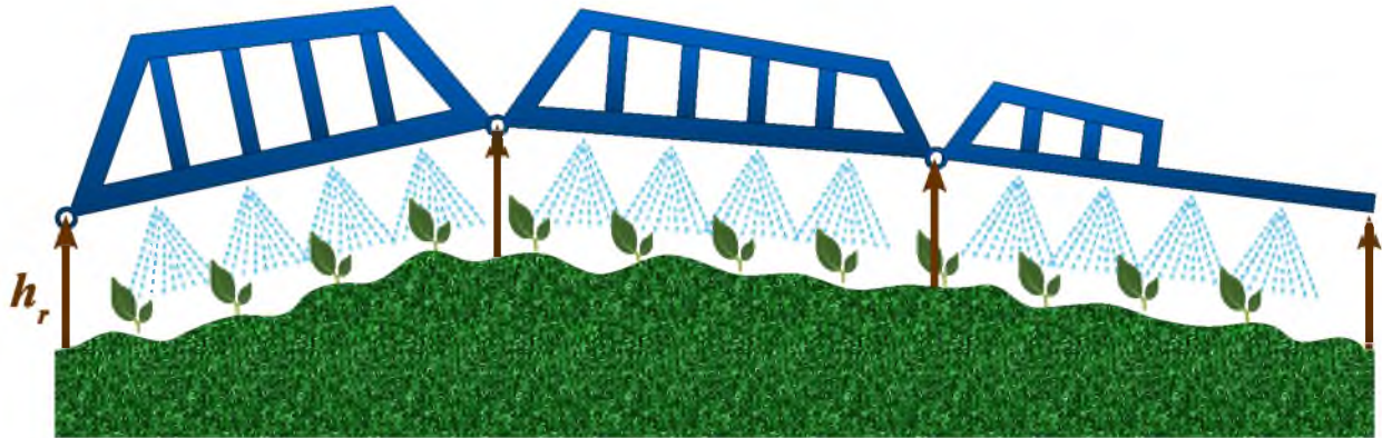
Figura 1.8: Compensación en la altura de las barras para efectuar una irrigación uniforme sobre la superficie del terreno.
