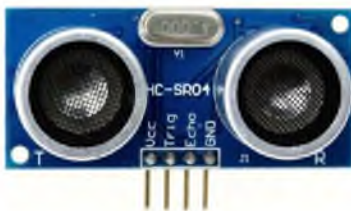
Figura 2.9: Sensor ultrasónico HC-SR04.
