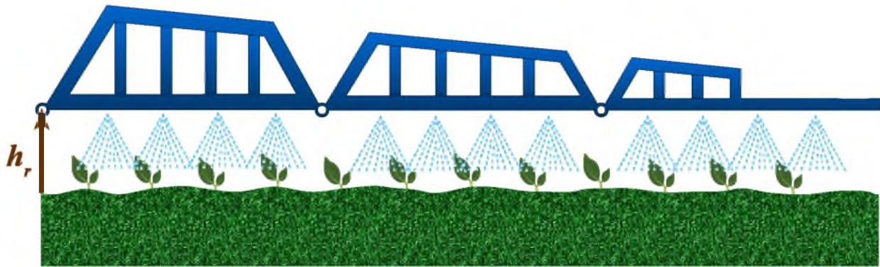
Figura 1.2: Irrigación por medio de las barras pulverizadoras en una superficie sin irregularidades.
