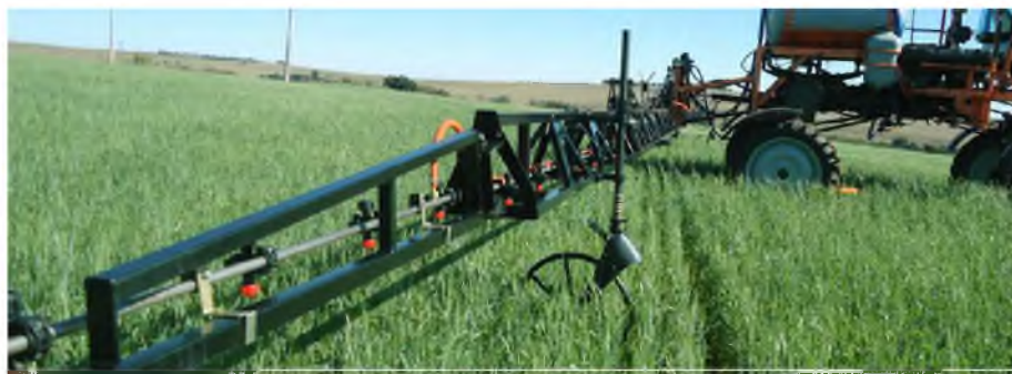
Figura 1.6: Sistema de control de altura por medio de sensores de barras KS instalado en un pulverizadora autopropulsada de la compañía PLA ver en [21].
