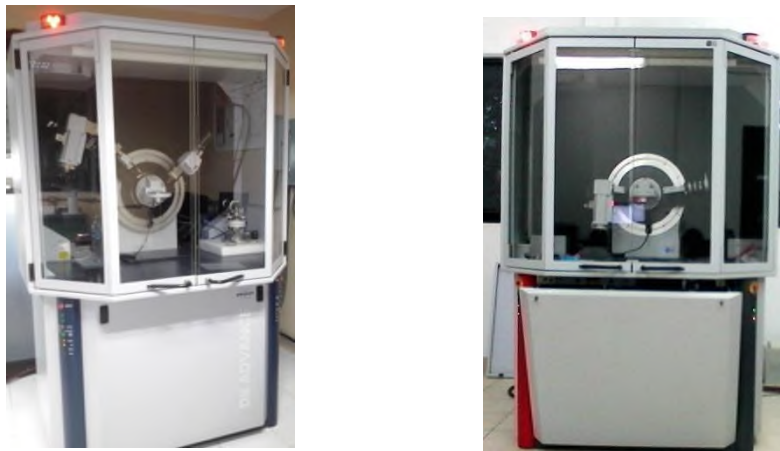
Figura 24. Difractómetros Bruker D8 Advance Cu K\alpha (izquierda) y Cu K\alpha_1 y K\alpha_2 (derecha).
