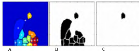
Figura 2.2: Aplicación de la transformada de Watershed con sus centros de masa (A), Objetos segmentados (B), identificación y selección de la imagen cardiaca (C).
