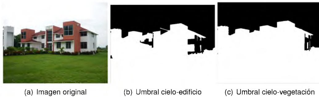
Figura 5.3: Resultado de aplicar el umbral cielo-edificio y cielo-vegetación a una imagen homogénea.
