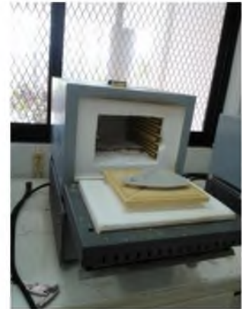
Figura 59 Cocción después del esmaltado Fuente: Propia
