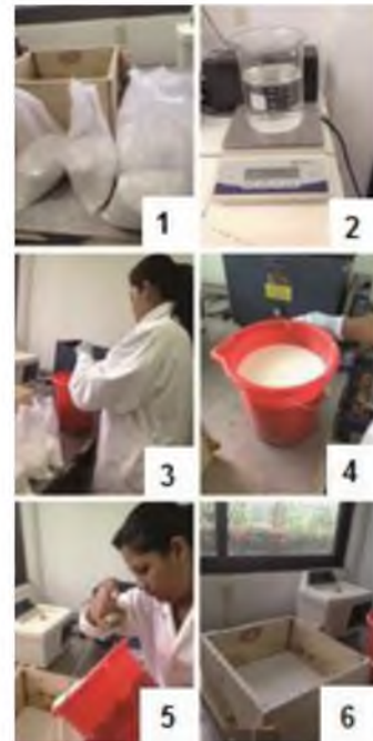
Figura 26 Procedimiento de elaboración de la placa de yeso. 1) y 2) Material pesado. 3) Mezcla de los materiales. 4) Mezcla homogénea. 5) Vaciado de yeso. 6) Yeso fraguado.
