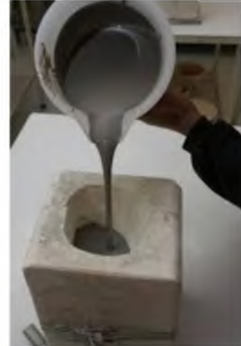
Figura 12 Vaciado de barbotina.
