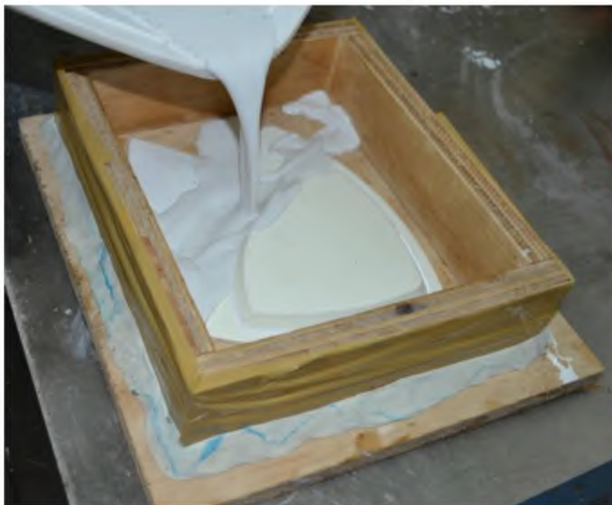
Figura 53 Vaciado de yeso. Fuente: Propia
