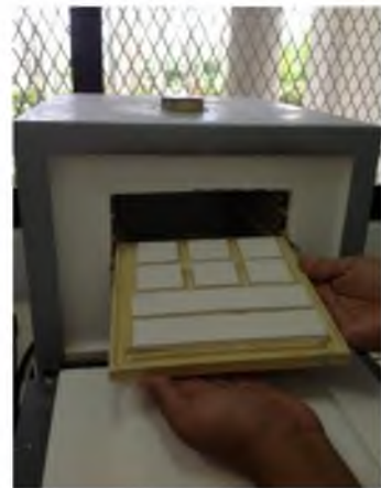
Figura 30 Cocción después de esmaltado.
