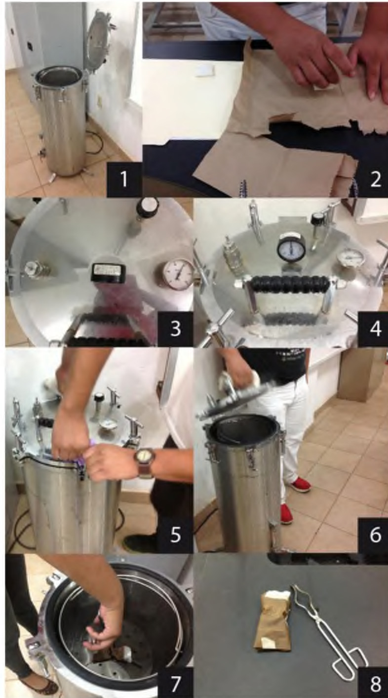
Figura 34 Esterilización. 1) Autoclave. 2) Envoltura de material. 3) Temperatura de 90 °C. 4) Temperatura y presión constante. 5) Apertura de válvula. 6) Apertura de autoclave. 7) Extracción de material. 8) Material esterilizado.
