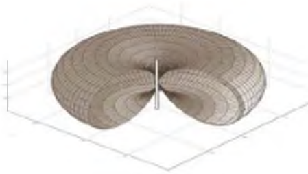
Figura 2.5: Patrón de radiación de una antena omnidireccional.
