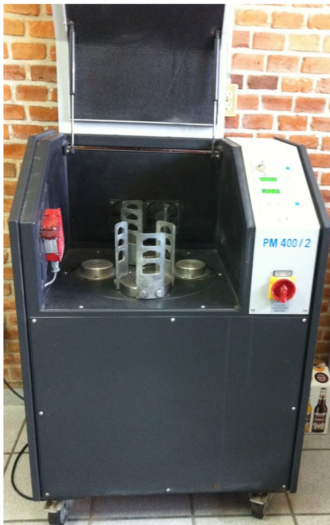
Figura 5. Molino planetario de bolas PM 400/2 marca Retsch.
