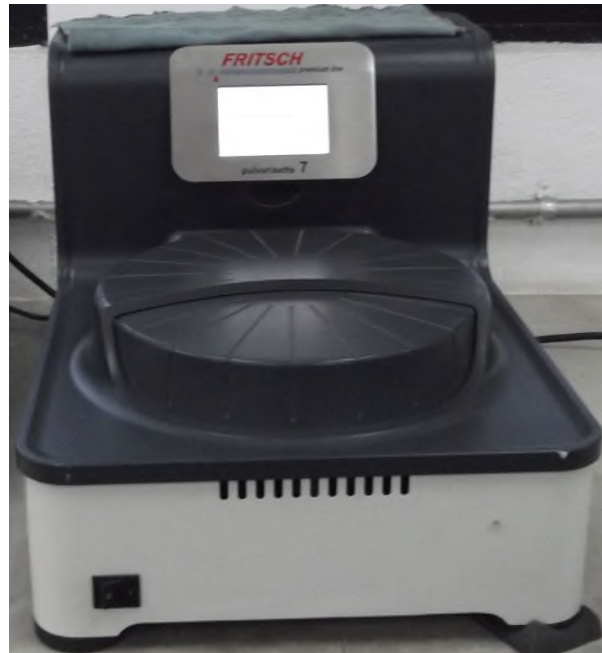
Figura 4. Molino planetario de bolas Pulverisette 7 premium line marca Fritsch.
