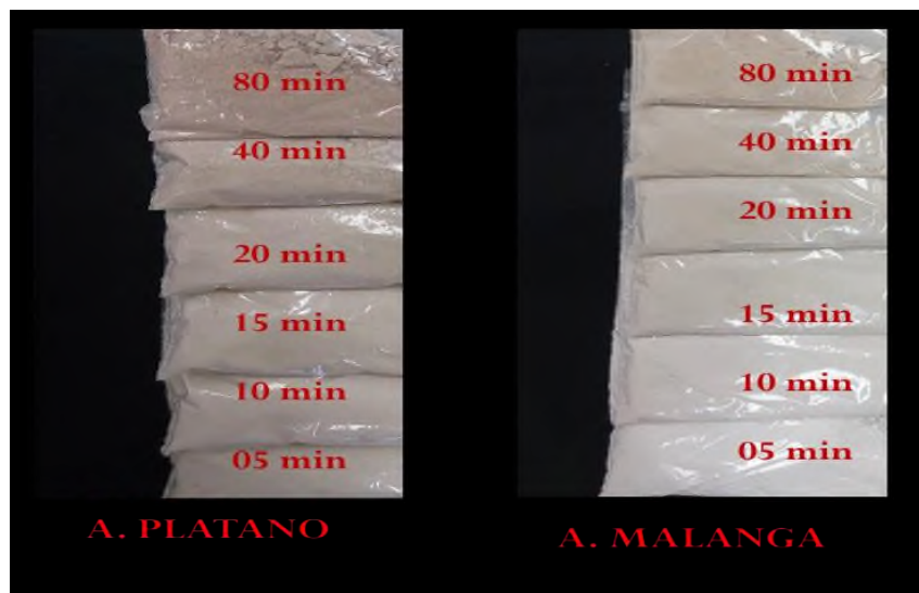
Figura 14.- Imagen de las muestras de almidón después del tratamiento de molienda.
