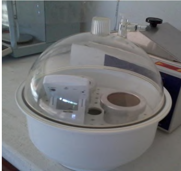
Figura 26. Celda con muestra en un desecador estabilizándose, para medir la permeabilidad al vapor de agua.
