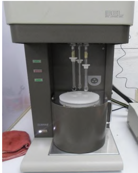
Figura 25. Equipo de medición del área superficial de las arcillas modificadas.
