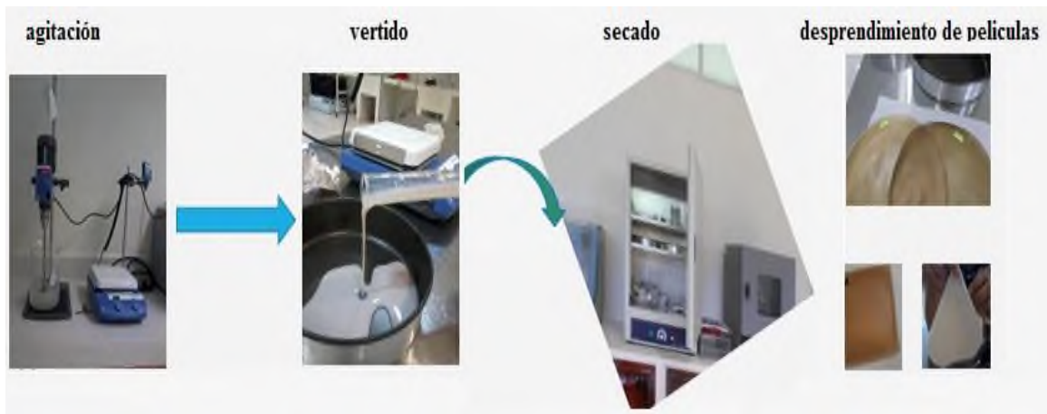
Figura 17. Proceso de elaboración de los nanocompuestos en película.
