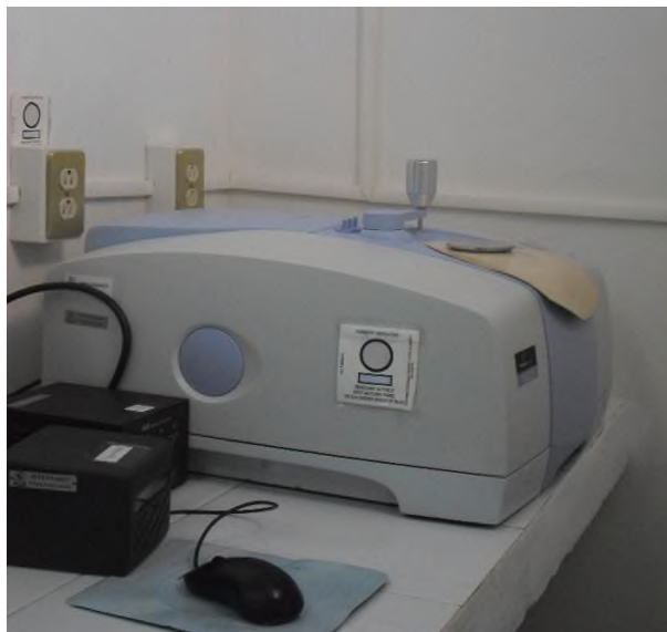
Figura 20. Espectrómetro FTIR utilizado para la medición de las muestras.
