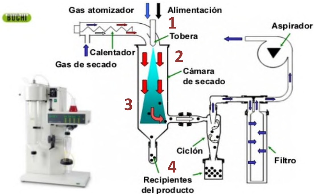
Figura 1.3 Etapas del proceso de secado por aspersión (Büchi, 2002; Gharsallaoui et al., 2007).
