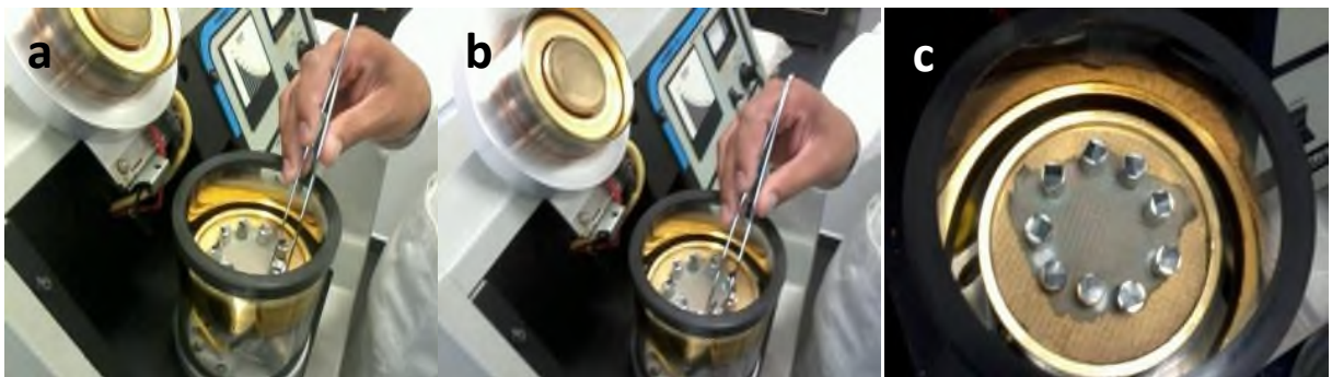
Figura 48. Técnica de recubrimiento con oro (Fuente: información obtenida por el técnico Diego A. Quiterio Vargas de IF-UNAM).
