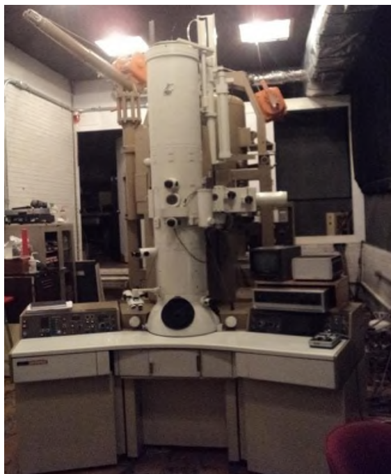
Figura 50. Microscopio Electrónico de Transmisión, JEOL 4000EX, IF-UNAM.
