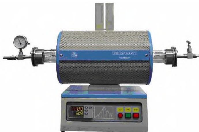
Figura 16. Horno tubular modelo GSL 1100.
