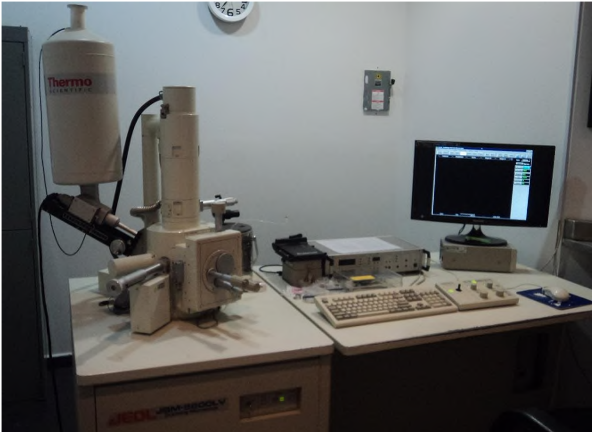
Figura 43. Microscopio Electrónico de Barrido, JEOL 5600 LV, IF-UNAM.
