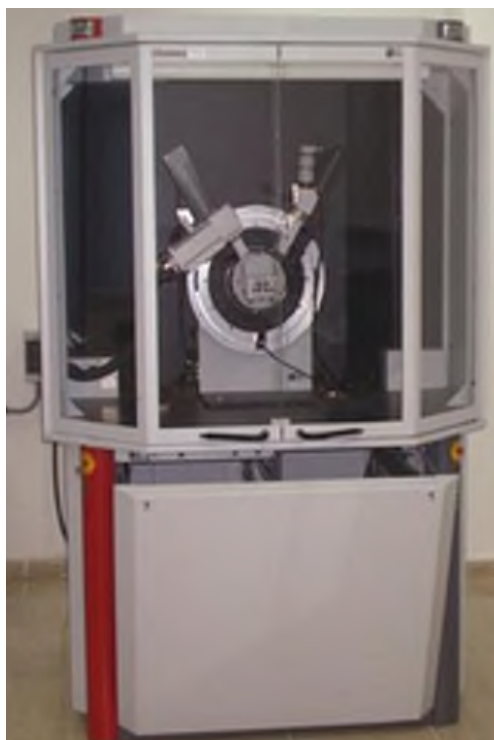
Figura 17. Difractómetro de Rayos X Bruker D8 Advance.
