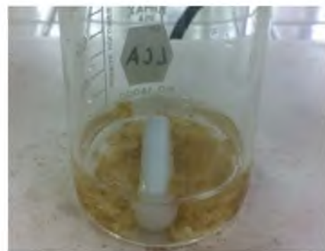
Figura. 4.26 Vaso de precipitados con 100 gr de muestra de papel claro diluida en 20 ml de agua desionizada.
