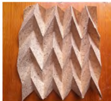
Figura 4.17 Dobleces con la el sistema de Ori Miura en el papel medio.
