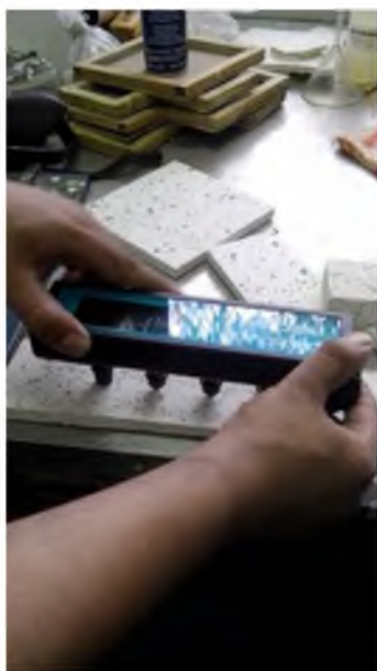
Figura 17: Equipo para medir la resistividad eléctrica del material (Fuente Propia)
