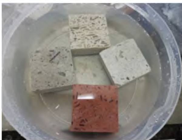
Figura 12: Inmersión de cubos de mortero en agua (Fuente Propia).
