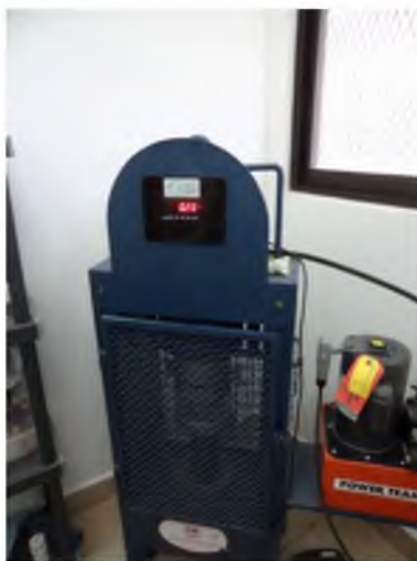
Figura 13: Prensa para ensayos de compresión (Fuente Propia)
