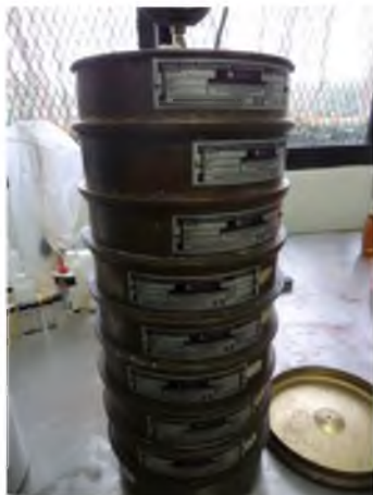
Figura 9: Tamices para realizar análisis granulométrico de la muestra de vidrio (Fuente Propia)
