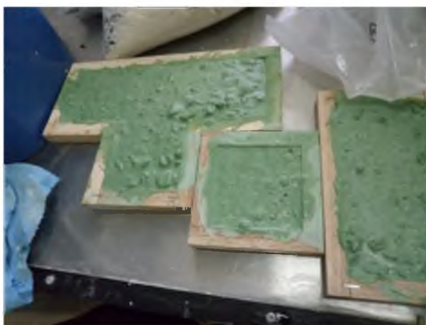
Figura 26: Muestras vaciadas a espera de fraguado: vidrio verde con cemento coloreado (Fuente Propia)
