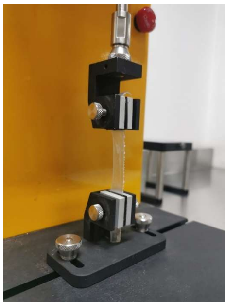
Figura 1. Fotografía de una película de almidón modificado durante su caracterización de propiedades mecánicas.
