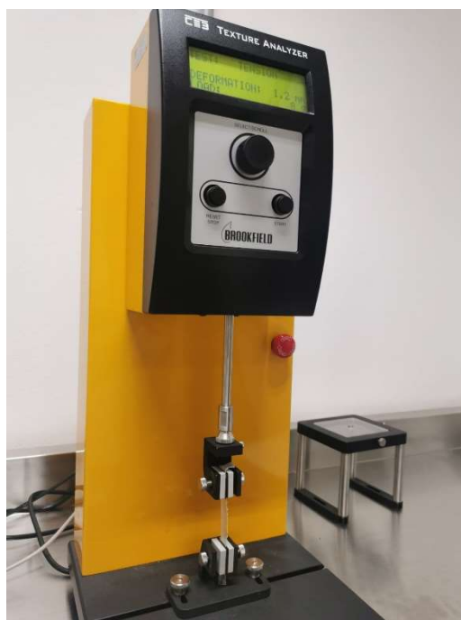
Figura 1. Fotografía de una película de almidón de papa modificado durante su caracterización de propiedades mecánicas.
