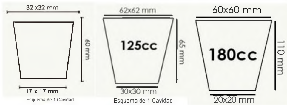
Figura 37. Medidas comerciales de las cavidades individuales de charolas germinadoras. Fuente: hydroenv.com.
