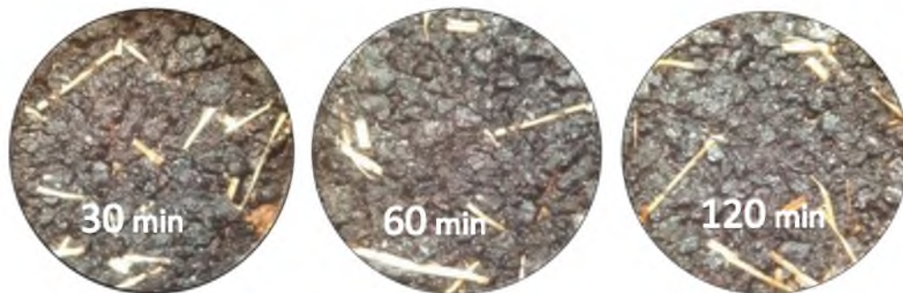
Figura 31. Pellets con fibra de hoja a 170 °C por 30, 60 y 120 minutos. Fuente propia.
