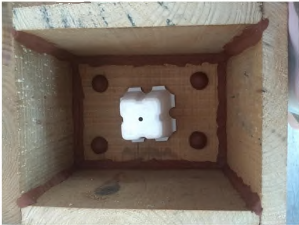
Figura 46. Modelo colocado y preparado para vaciar el yeso. Fuente propia.
