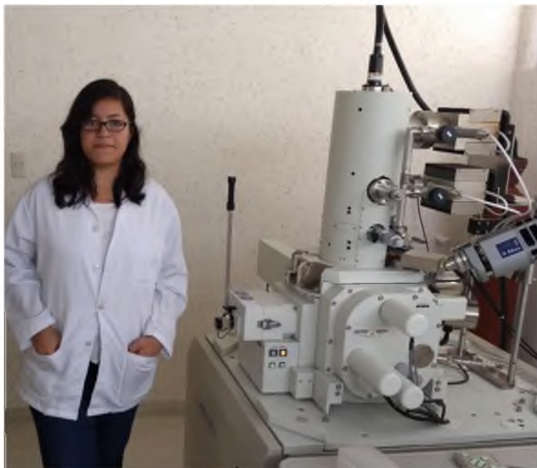
Figura 6. Equipo de microscopía electrónica de barrido JEOL JSM-7600F en el MICRONA. Fuente propia.
