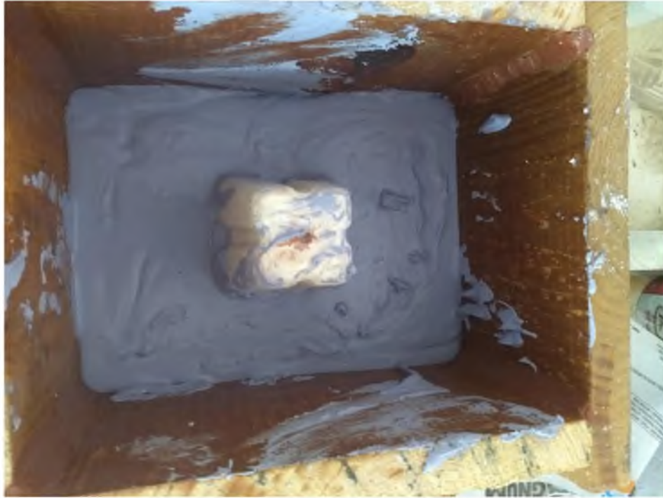
Figura 47. Elaboración de molde de yeso. Fuente propia.
