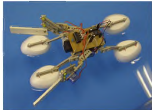
(b) Robot acuático: Robot zapatero, camina sobre el agua.
