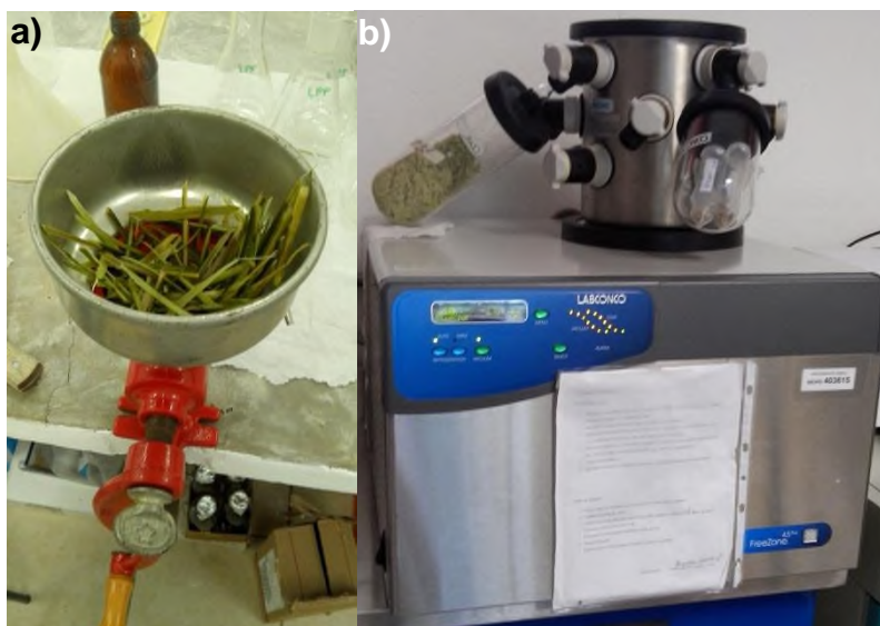
Figura 9: a) Molino manual con Smilax sp. y b) Equipo de liofilización con material vegetal molido.
