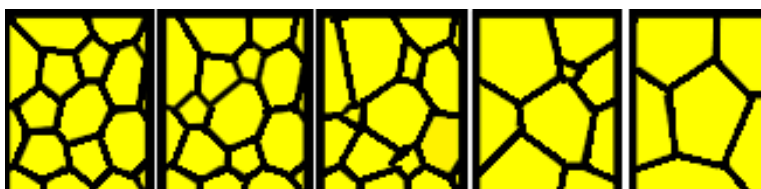
Figura 4: Aspectos de la evolución de una espuma debido a la Maduración de Ostwald.
