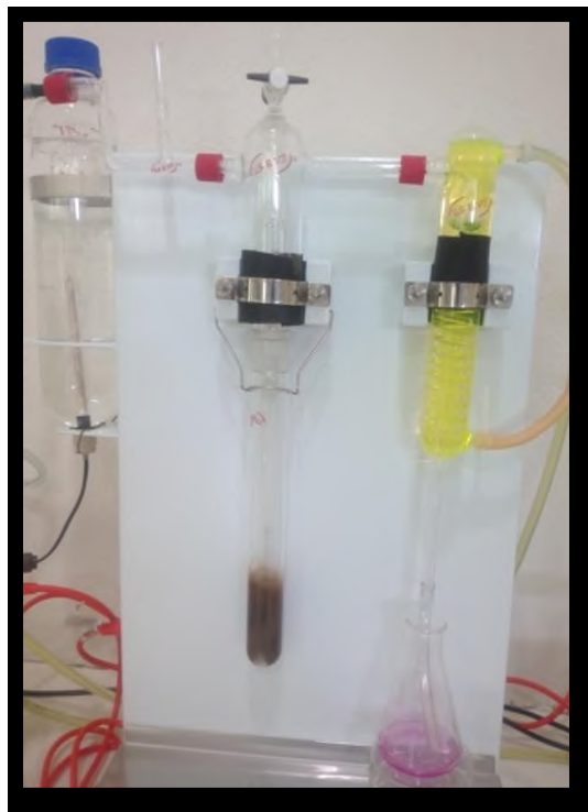
Figura 16. Equipo microkjeldahl para cuantificación de proteínas
