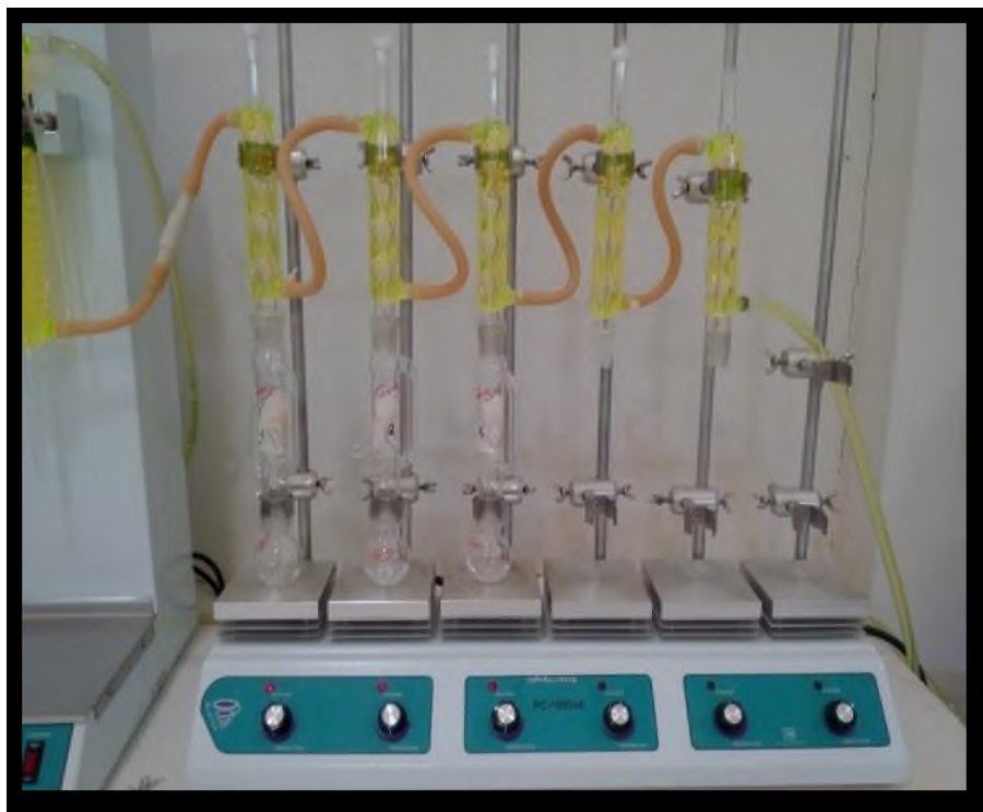
Figura 15. Equipo Soxhlet para cuantificación de lípidos
