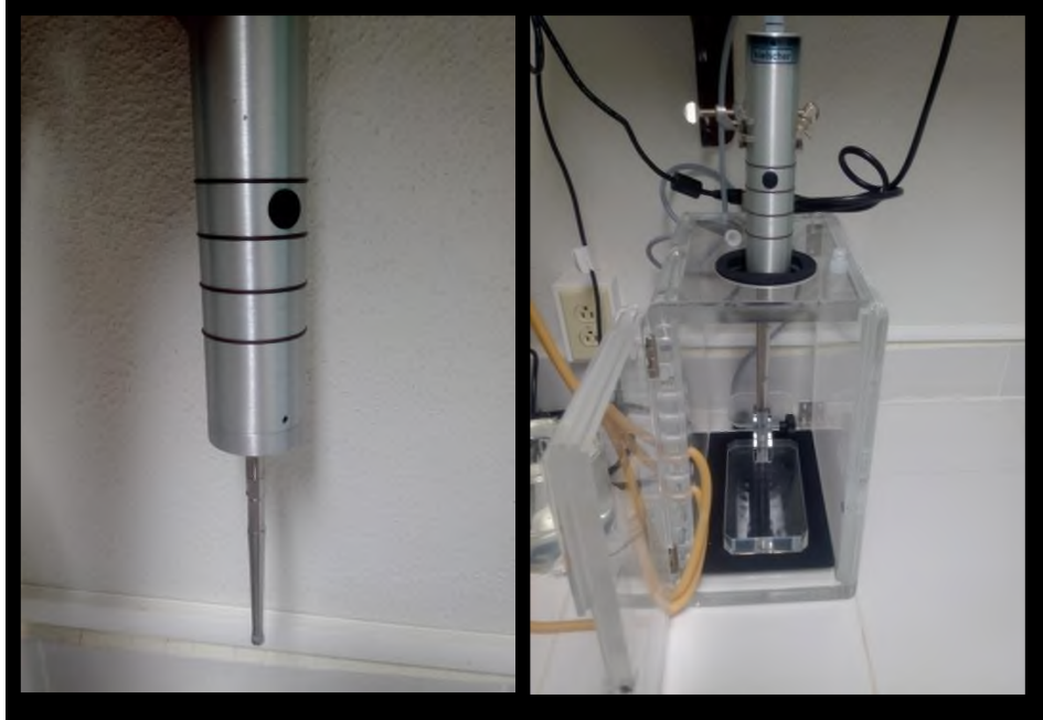
Figura 7. Equipo de ultrasonido utilizado para el tratamiento del jugo
